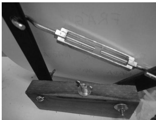
Figura 25: sistema de parafusos para ajuste da embocadura
