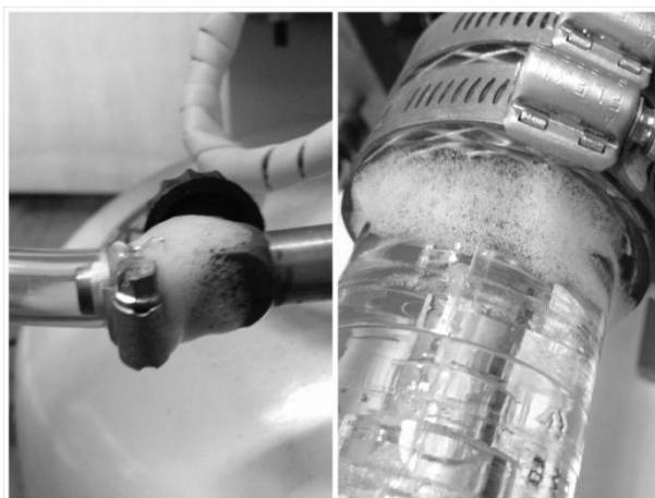
Figura 26: detalhe dos testes de vazamento dos encaixes
