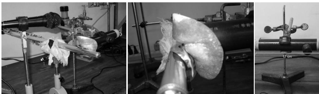
Figura 1: à esquerda, experimento realizado, ao centro, detalhe da embocadura, à direita, trato vocal artificial feito em PVC (COELHO, 2006: 29, 31, 33).
