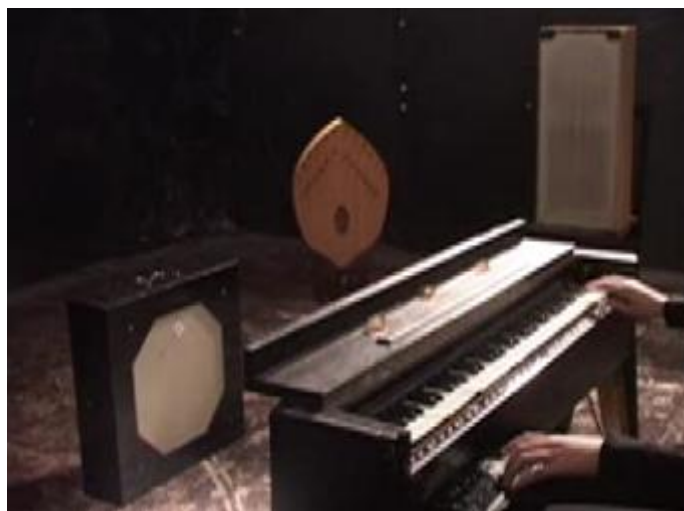
Fig. 2.1 – Ondes Martenot e seus ressonadores. Da direita para a esquerda: gongo metálico, palme e alto falante principal 22 .
