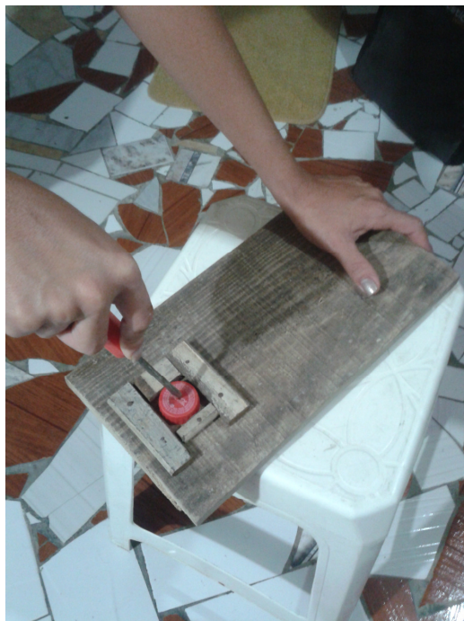
Figura 7. Furando a tampa com o suporte desenvolvido.
